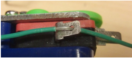
Kuva 8. Johto kuorittuna keskeltä.
